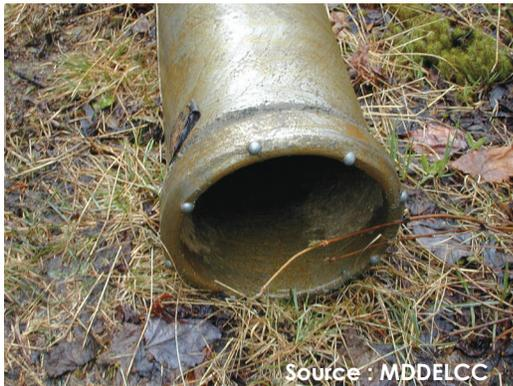
Le sabot d'enfoncement constitue le renflement situé à l'extrémité du tubage de l'image ci-contre. Il est soudé au tubage préalablement à son enfoncement dans le forage. Les pointes grises qui apparaissent sur le sabot sont des pointes au carbure dont la dureté facilite l'enfoncement du sabot dans le roc lors du battage au refus.
